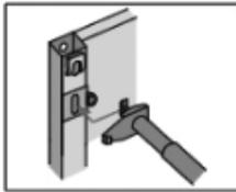
1: 縦梁のサポート取付孔に一方のT型連結部を入れます。
