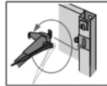
3: 伸縮ボルトを回しサポートの長さを調整し他方のT型連結部を取付孔に入れます。付属のラチェットレンチを使うと簡単に伸縮できます。
