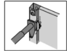
4: 両方の取付ハンドルを大型バール等を利用して回転させ、サポートを完全に固定させ、サポートロック金具をスライドさせ、サポートをロック状態にしRピンで固定してください。
